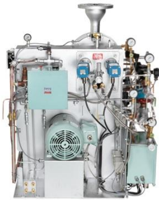
オイル/ガス混焼 バーナ本体
